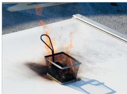
Diese Membran hält selbst brennende Holzwolle (-kohle) aus. Genau das könnte für Zeltbauer und Hallenvermieter dort interessant werden, wo eben B1 allein nicht mehr reicht.
