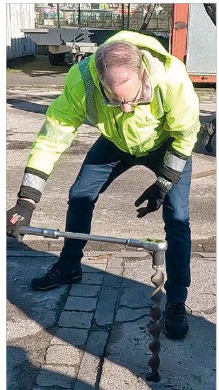
Der Spirafix lässt sich durch einfaches Herausdrehen lösen – mit einer großen Ratsche.
